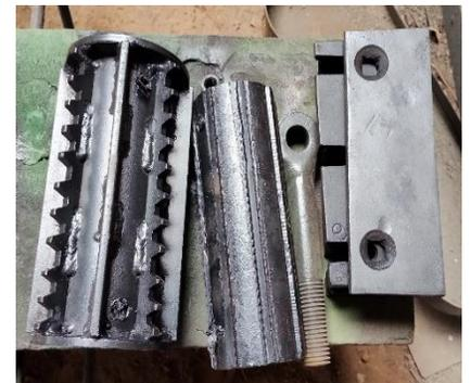
Cuchillas anti abrasivos y rodillos aladores
